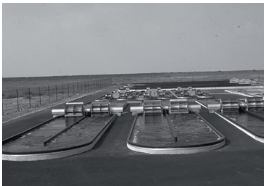
Fig. 3. Système de culture en extérieur du type Raceway (Société Inovalg (85)).
